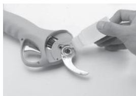
6. Quando si sostituiscono le lame, è necessario aggiungere olio lubrificante nel mezzo.
