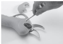
2. Отстранете винтовете от закрепване на гайката на острието (тази стъпка е критична).
