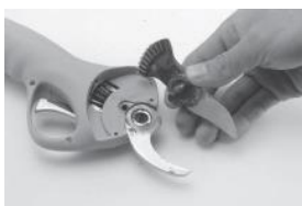
4. Отвийте щифта и извадете движещото се острие
