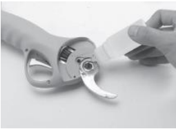
6. Lors du remplacement des lames, il faut ajouter de l'huile de graissage entre les deux.
