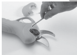
2. Rimuovere le viti dal fibbia di fissaggio del dado della lama (questo è fondamentale).
