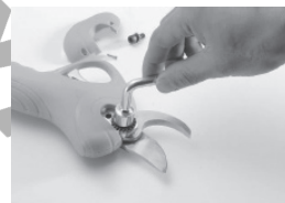
3. Remove the blade nut.
