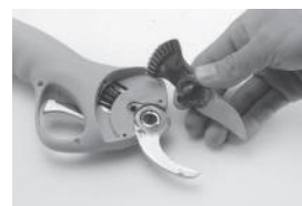
4. Deșurubați știftul și îndepărtați lama în mișcare
