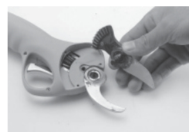
4. Izvijte zatič in odstranite premikajoče se rezilo
