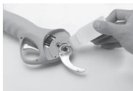
6. При смяна на остриетата, между тях трябва да се добави смазочно масло.
