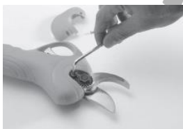
2. Îndepărtați șuruburile de la piulița de fixare a piuliței lamei catarama de fixare (acest este esențială).
