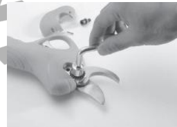
3. Retirer l'écrou de la lame.
