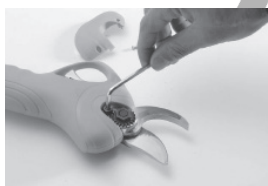
2. Αφαιρέστε τις βίδες από την πόρπη συγκράτησης του παξιμαδιού της λεπίδας (αυτό το βήμα είναι κρίσιμο).
