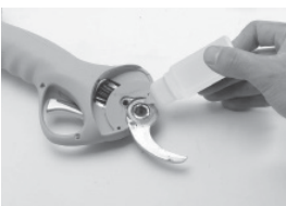
6. Quando si sostituiscono le lame, è necessario aggiungere olio lubrificante tra una lama e l'altra.
