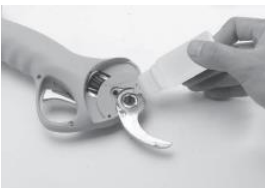
6. Lors du remplacement des lames, il est nécessaire d'ajouter de l'huile de lubrification entre les deux.
