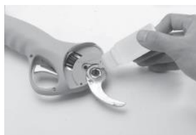
6. La înlocuirea lamelor, este necesar să se adauge ulei de lubrifiere între ele.
