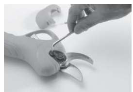
9. Поставете фиксиращата гайка.
