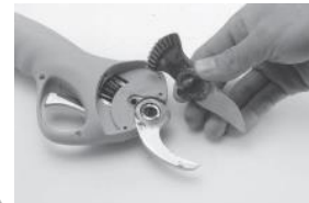
4. Dévisser la goupille et retirer la lame mobile.
