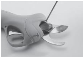
1. Отвийте винтовете с отвертка и отворете капака.
