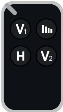
**Bouton V1 :** Contrôle la ligne laser verticale à l'avant de l'appareil.
