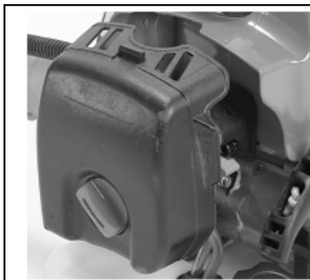
5. Počakajte nekaj časa in nastavite ročico dušilke v položaj ON.
