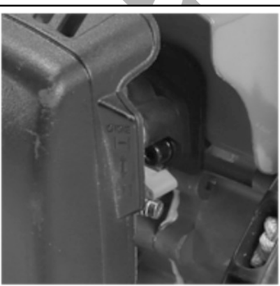
2. Stikalo motorja obrnite v položaj ON.
