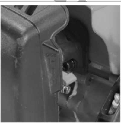
2. Завъртете превключвателя на двигателя в положение ON.
