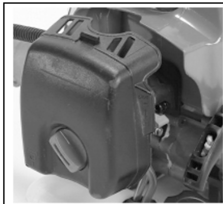
3. Поставете лоста на дроселовата клапа в положение OFF
