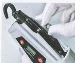
7. Αντικαταστήστε τον ελαστικό τροχό με ένα νέο. Σιγουρευτείτε ότι το αυλάκι στον ελαστικό τροχό είναι στραμμένο προς τα έξω
