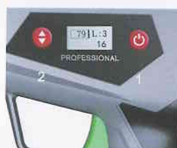
12. Ενεργοποιήστε την τροφοδοσία, πατήστε και κρατήστε πατημένο το κουμπί εναλλαγής για 1 δευτερόλεπτο, και μετά ενεργοποιήστε τη σκανδάλη όταν ακούτε έναν ήχο "D".
