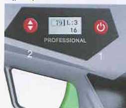
5. Ενεργοποιήστε την τροφοδοσία, πατήστε και κρατήστε πατημένο το κουμπί αλλαγής ταχυτήτων για 1 δευτερόλεπτο και μετά ενεργοποιήστε το όταν ακούτε έναν ήχο "D"
