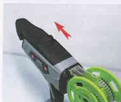
1. Εάν το εργαλείο έχει κολλήσει ή δεν μπορεί τροφοδοτήσει το νήμα, πατήστε τον διακόπτη για να πιέσετε το μπροστινό κάλυμμα
