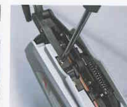
3. Χαλαρώστε τις βίδες στην αριστερά πλάκα κάλυψης
