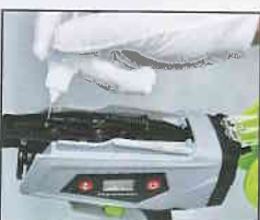
5. Αφού ολοκληρωθεί η διαδικασία καθαρισμού, λιπάνετε το εργαλείο και κάθε κινητό σύνδεσμο (όπως φαίνεται στο σχήμα)
