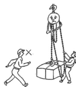
În cazul în care forța de tracțiune a lanțului manual depășește forța normală, nu trageți prin creșterea forței. Opriți imediat funcționarea și inspectați troliul.
