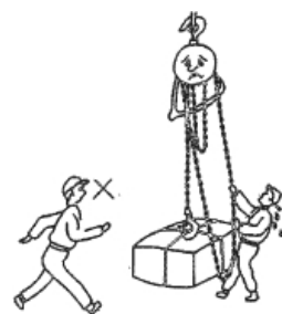
W przypadku, gdy siła ciągnięcia łańcucha ręcznego przekracza normę, nie należy ciągnąć ze zwiększoną siłą. Natychmiast przerwać pracę i sprawdzić wciągnik.
