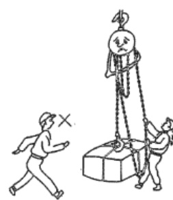
U slučaju da sila povlačenja ručnog lanca prelazi normalno, ne povlačite povećanjem sile. Odmah zaustavite rad i pregledajte dizalicu.
