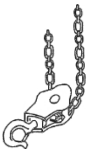
Brak bocznego ciągnięcia.
