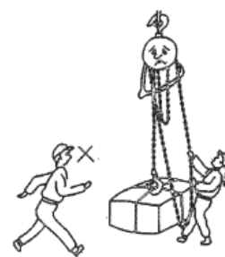
Če je sila vleka ročne verige večja od običajne, ne vlecite s povečano silo. Takoj ustavite delovanje in preglejte dvigalo.
