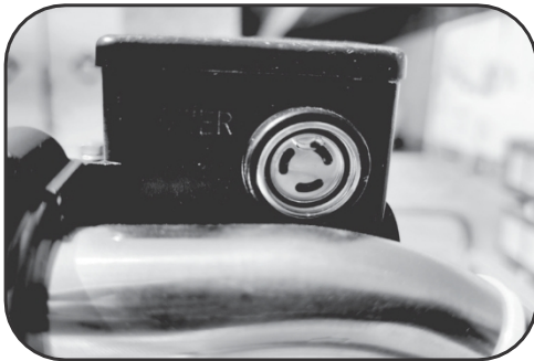
Skrzynka oleju hydraulicznego
