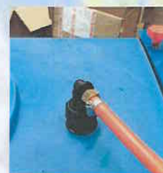
ΕΞΩΤΕΡΙΚΗ ΟΨΗ ΣΥΝΔΕΣΗΣ ΑΝΑΔΕΥΤΗΡΑ ΠΑΝΩ ΣΤΟ ΔΟΧΕΙΟ
