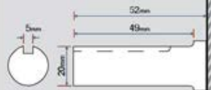
ΣΧΕΔΙΟ 6 ΣΦΗΝΑ 20mm ΓΙΑ ΜΕΙΩΤΗΡΑ
